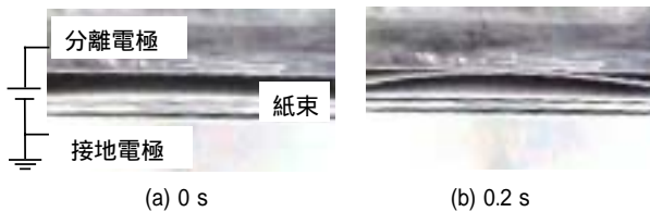
図1 静電力を利用した紙分離機構
